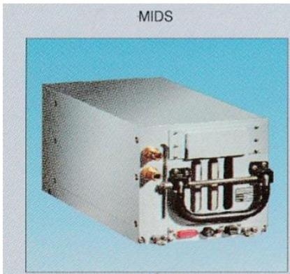
Les cinq nations principales de l'OTAN ont développé le terminal MIDS-LVT (Multifunctional Information Distribution System - Low Volume Terminal). Ce terminal contient toutes les fonctions nécessaires à l'exploitation de la LADT L16, c'est à dire émission-réception, chiffrement, modulation, transmission des messages et gestion du réseau selon un protocole très complexe.
