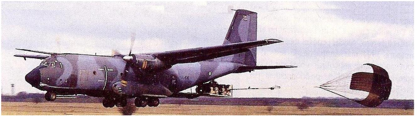
Une action typique d'aérolargage : tandis que le C-160 porteur survole la bande d'atterrissage, train sorti, à 3 m au-dessus du sol, un parachute extracteur assure l'éjection de la lourde palette qui prendra contact avec le sol à l'horizontale.
