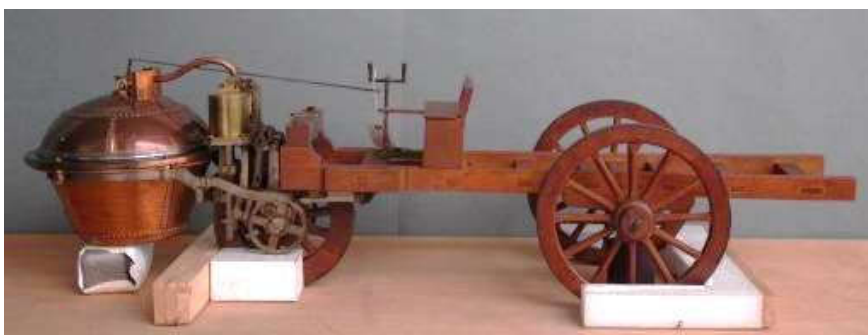
Nicolas Joseph Cugnot (1725-1804) : ingénieur militaire français. A conçu et réalisé, entre 1769 et 1771, le premier véhicule automobile jamais construit. Il s'agit d'un fardier d'artillerie, mû par une machine à vapeur à deux cylindres, conservé en parfait état au musée des arts et métiers à Paris.
