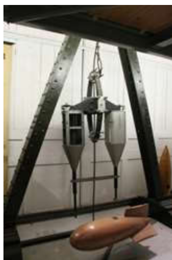
Matériel mis au point par Gustave EIFFEL pour ses expériences sur la résistance de l'air
