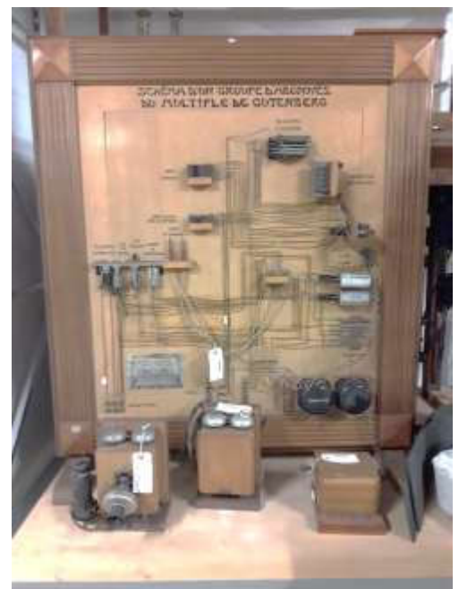
Schéma d'un groupe d'abonnés du multiple de Gutenberg Vestiges de l'ancien central téléphonique Gutenberg à Paris, qui prit feu en 1908
