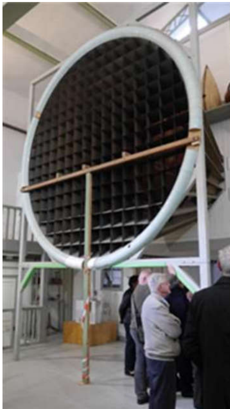
Entrée d'air de la soufflerie
